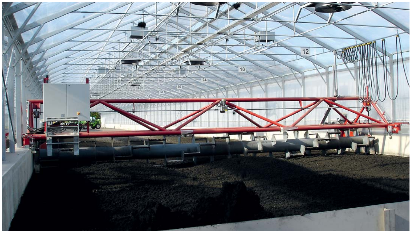
Die Wende- und Förderanlage vom Typ Wendewolf® Fotos 1+2 mit freundlicher Genehmigung der IST-Anlagenbau Bild 2
